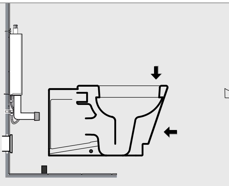
Predisporre l'altezza corretta dell'entrata acqua della cassetta a muro. Applicare il raccordo (non fornito) allo scarico del WC. Posizionare il WC allineando lo scarico con il foro a muro precedentemente predisposto; contemporaneamente innestare entrambe le connessioni, della cassetta di scarico a muro e dello scarico del WC. ATTENZINE: Per agevolare l'innesto dei raccordi dell'entrata e uscita acqua si consiglia di lubrificare entrambe le parti.
