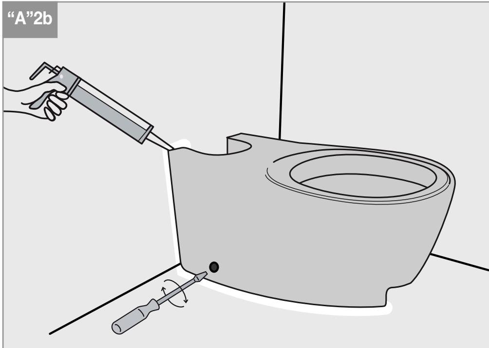
Appicare un leggero strato di silicone nel perimetro del sanitario che è a contatto con il muro e il pavimento. Raccomandiamo di utilizzare un silicone universale anti muffa. Rimuovere gli eccessi di silicone aiutandosi con carta assorbente. Serrare le viti di fissaggio fornite nel kit e precedentemente predisposte nel pavimento.
