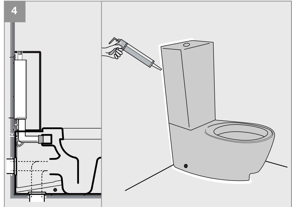
Applicare un leggero strato di silicone nel perimetro del sanitario che è a contatto con la cassetta di ceramica e il pavimento. Raccomandiamo di utilizzare un silicone universale anti muffa. Rimuovere gli eccessi di silicone aiutandosi con carta assorbente.
