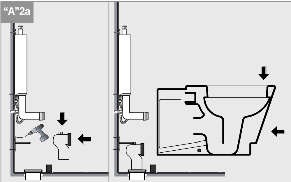
Predisporre l'altezza corretta dell'entrata acqua della cassetta a muro. Innestare la curva tecnica, fornita nella scatola, al foro di scarico a pavimento e fissarla a muro con l'apposita staffa. Posizionare il WC allineandolo con la curva montata a pavimento; contemporaneamente innestare entrambe le connessioni, della cassetta di scarico a muro e dello scarico del WC. ATTENZIONE: Per agevolare l'innesto dei raccordi dell'entrata e uscita acqua si consiglia di lubrificare entrambe le parti.
