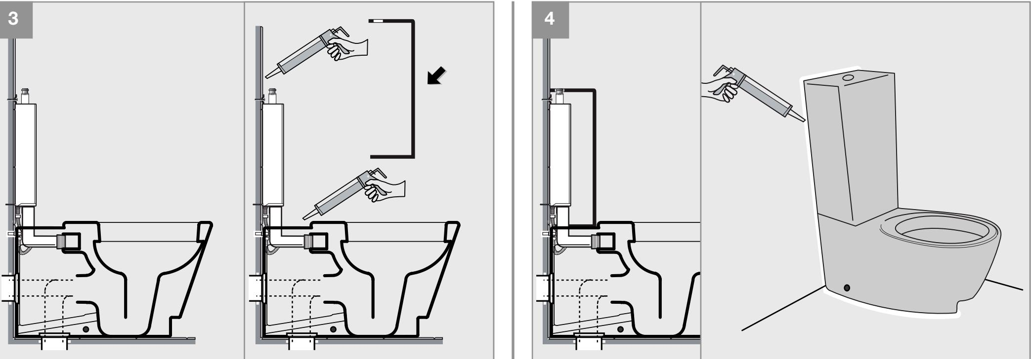
Applicare un leggero strato di silicone nel perimetro della cassetta di ceramica e inserirla come copertura alla cassetta di scarico attaccata a muro. Rimuovere gli eccessi di silicone aiutandosi con carta assorbente. Fissare il bottone di scarico cromato della cassetta che comanda lo scarico dell'acqua.
